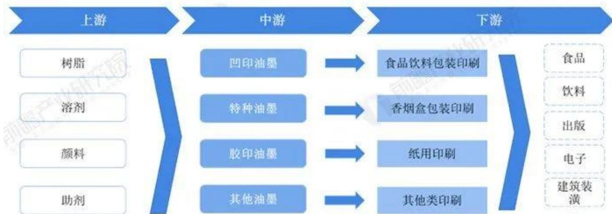
从上游原材料来看，油墨的原材料大致可以分为树脂、溶剂、颜料、助剂四大类别。颜料是颗粒极细的有色物质，决定油墨的颜色、着色力、色度，以及耐酸、耐碱、耐光、耐水等性能，约占油墨构成的10%-20%。
